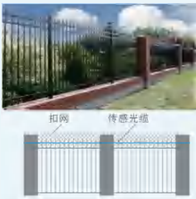
增加扣网，一字型铺设
